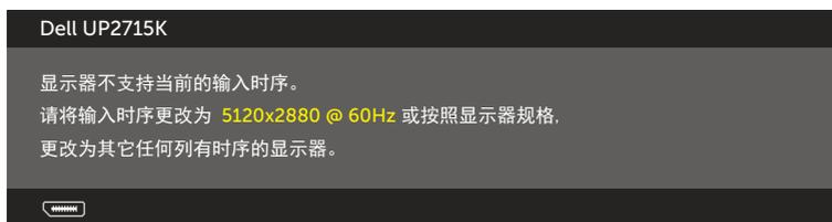
这表示显示器不能与它从计算机接收的信号同步。请参见[显示器规格](#)了解此显示器支持的水平和垂直频率范围。推荐模式是5120 x 2880。
